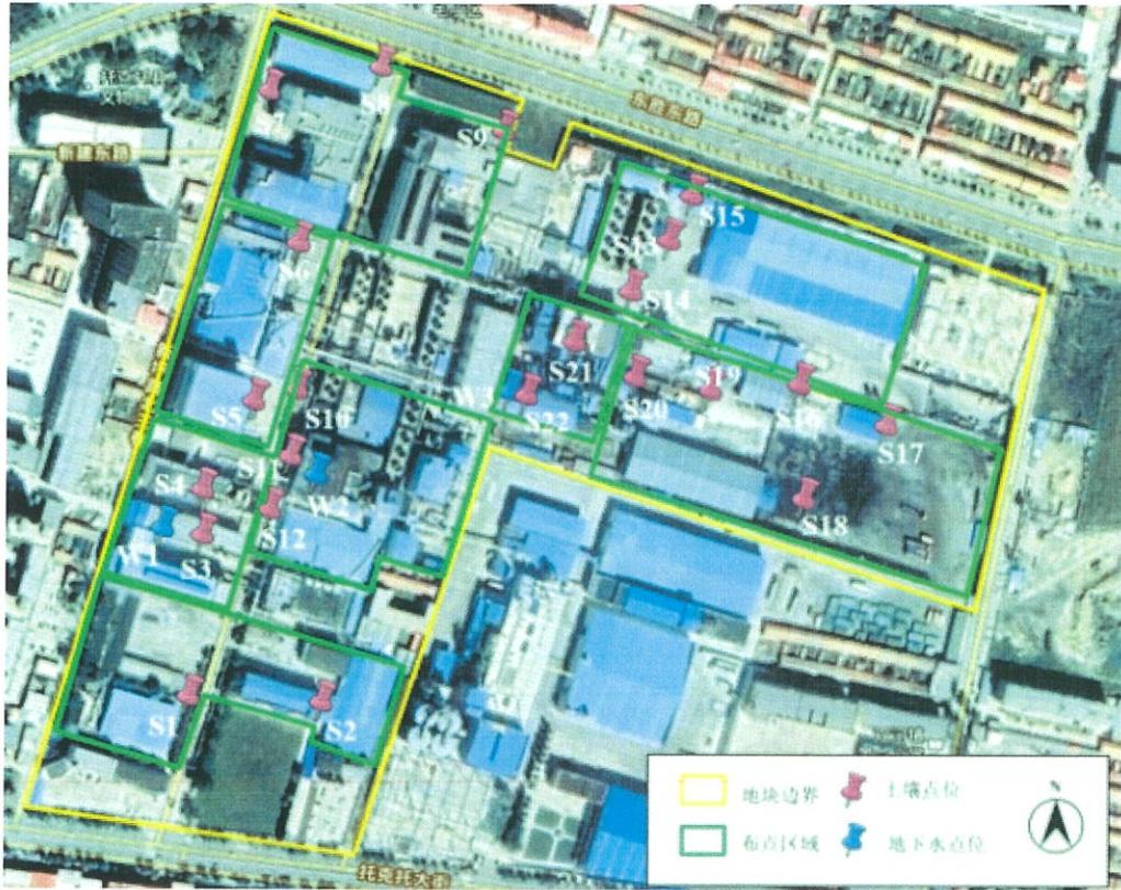
图 6-2 土壤和地下水监测点位布置图
